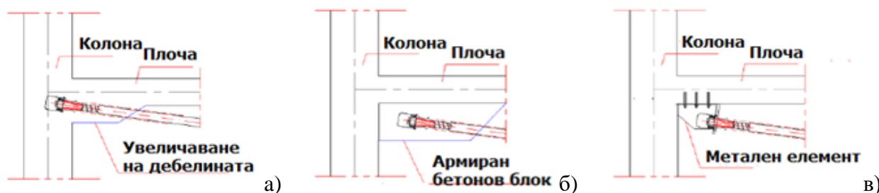
Фигура 5. Различно разположение на анкерни устройства [1]
