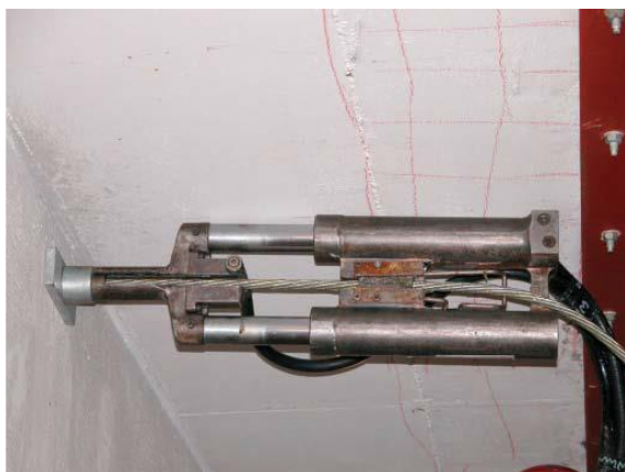
Фигура 10. Преса с прихващащо действие за напрягане на единични въжета [13]
