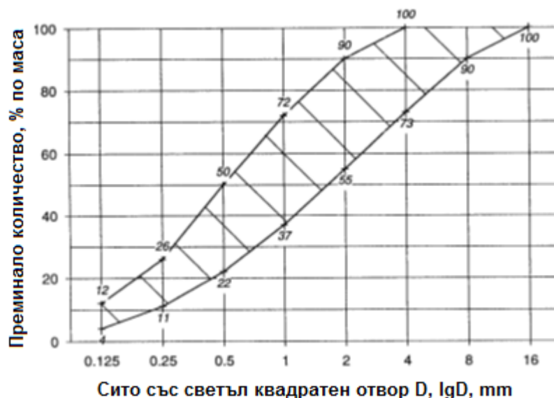
Фигура 1. Препоръчителна зърнометрична крива на добавъчен материал за пръскан бетон, съгласно [3]
