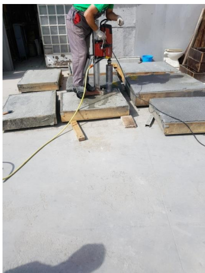
Фигура 3. Изрязване на сондажни ядки
