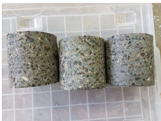
Фигура 8 WS - общ вид на пробните тела след 5 цикъла – нулева загуба на маса
