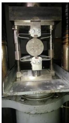
Фигура 7. Определяне на якост на опън при разцепване
