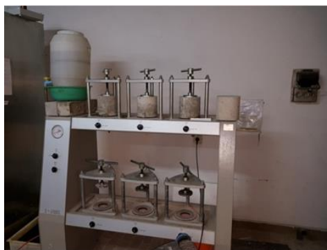
Фигура 6. Определяне на дълбочина на проникване на вода под налягане
