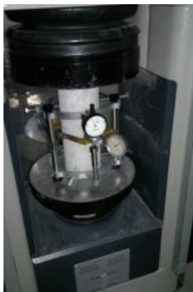
Фигура 6. Опитна постановка за определяне на статичния модул на еластичност при натиск
