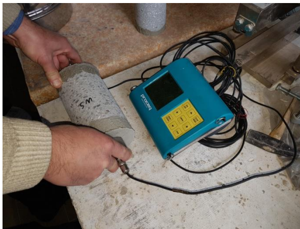
Фигура 5. Прозвучаване с ултразвуков апарат
